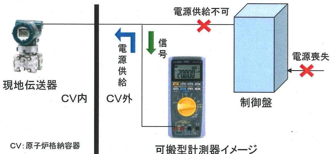
(伝送器に電源供給し、伝送器からの信号を計測可能)
