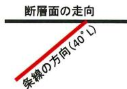
断層面に直交、条線方向(レイク40L)に平行な断面
