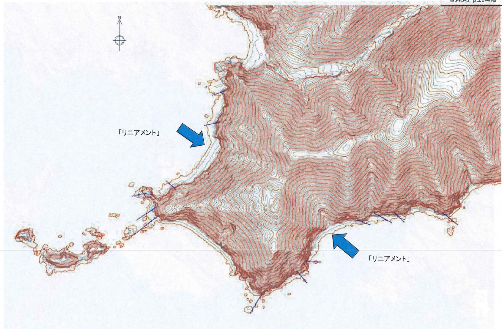
航空レーザー測量を行い詳細DEMより作成した地形図、及び現地踏査ではリニアメントは認められない。
