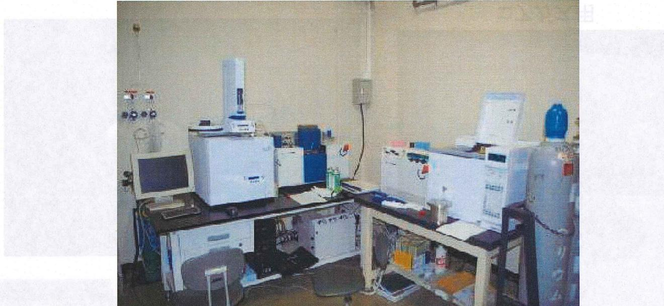
連続フロー燃焼炉同位体比質量分析計GCCIRMS
