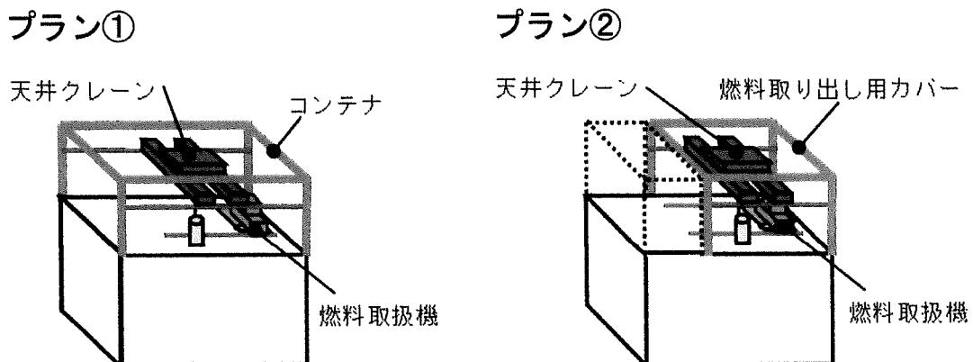
図2 2号機の燃料取扱設備等（イメージ図）
