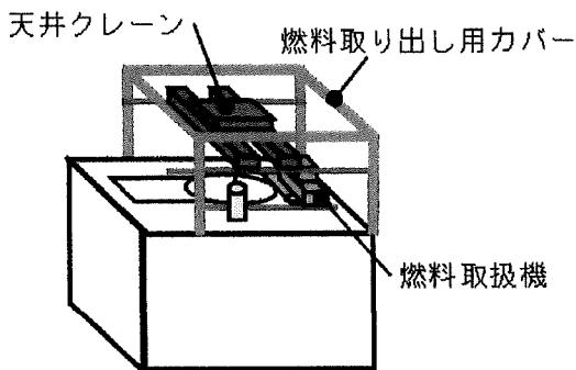
図1 1号機の燃料取扱設備等（イメージ図）
