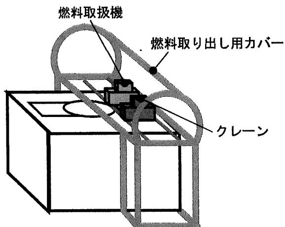
図3 3号機の燃料取扱設備等（イメージ図）
