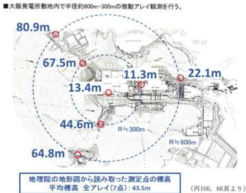
図 2.1. 微動アレイ観測の観測点の標高. 標高は 11~81m、平均標高は約 43.5m
