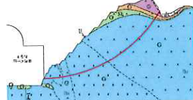
CH級岩盤内のすべり
