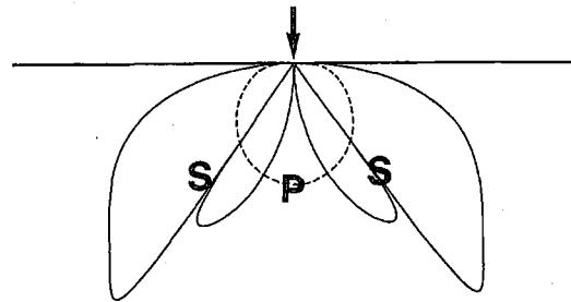
第9図 一点に加わる圧縮力によって生じる各方向のP波、S波の振幅(大澤ほか, 1995より)
