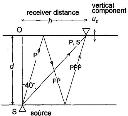
第14図 反射波の波線 表記法は Aki and Richards (1980)に基づき、~と-はそれぞれ上面で反射して下面に、下面で反射して上面に向かう波を示す。
