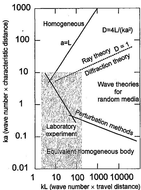
第1図 弾性波の散乱を研究するための手法の分類と適用理論の範囲を  $kL-ka$  グラフで示したもの
