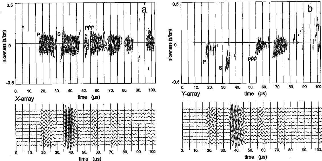
第12図 湯河原安山岩における直交アレイによる観測波形、及びセンブランス値の高い部分をスローネスに対してプロットした図
