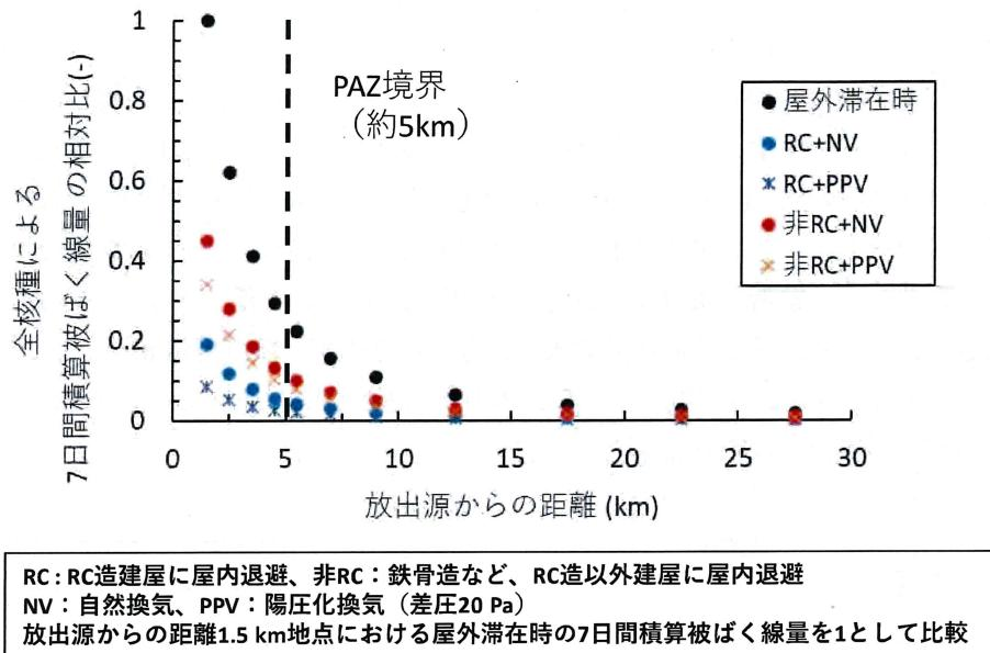
図3 放出源からの距離と7日間積算被ばく線量の相対比（全核種）
