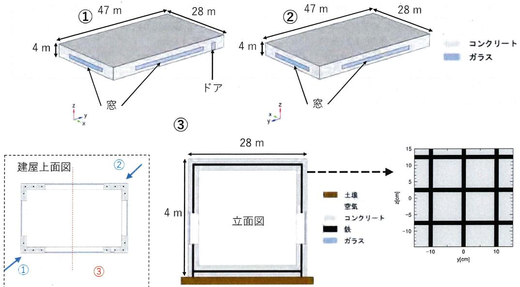
図 6-1 RC 造建屋モデル
