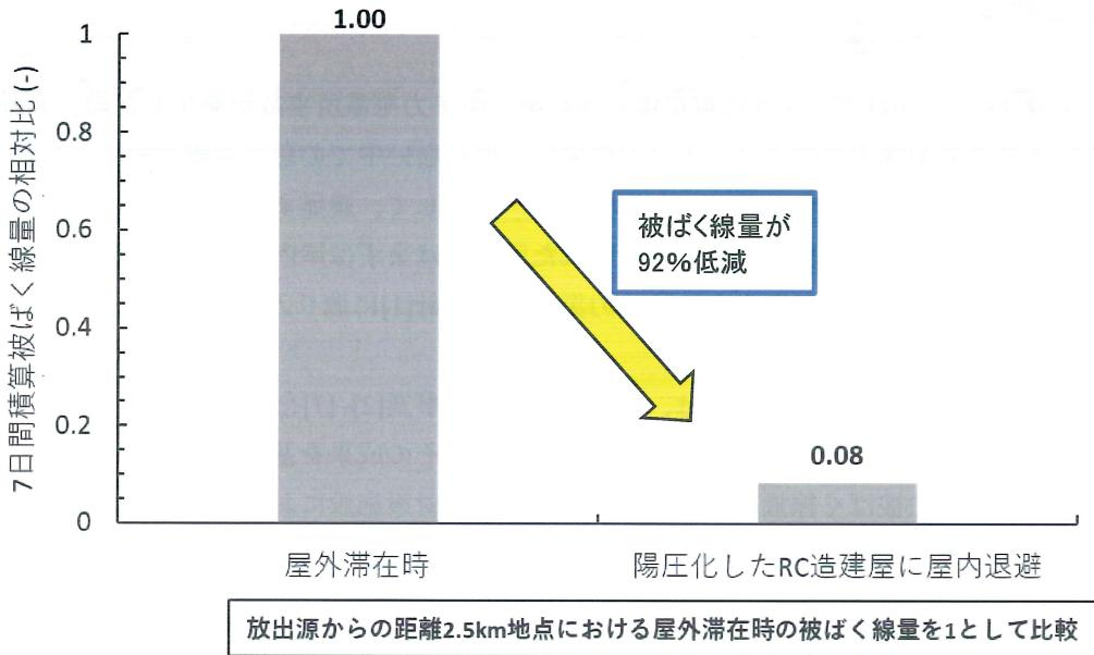
図 放射線防護対策が講じられた建屋への屋内退避による被ばく線量低減効果
