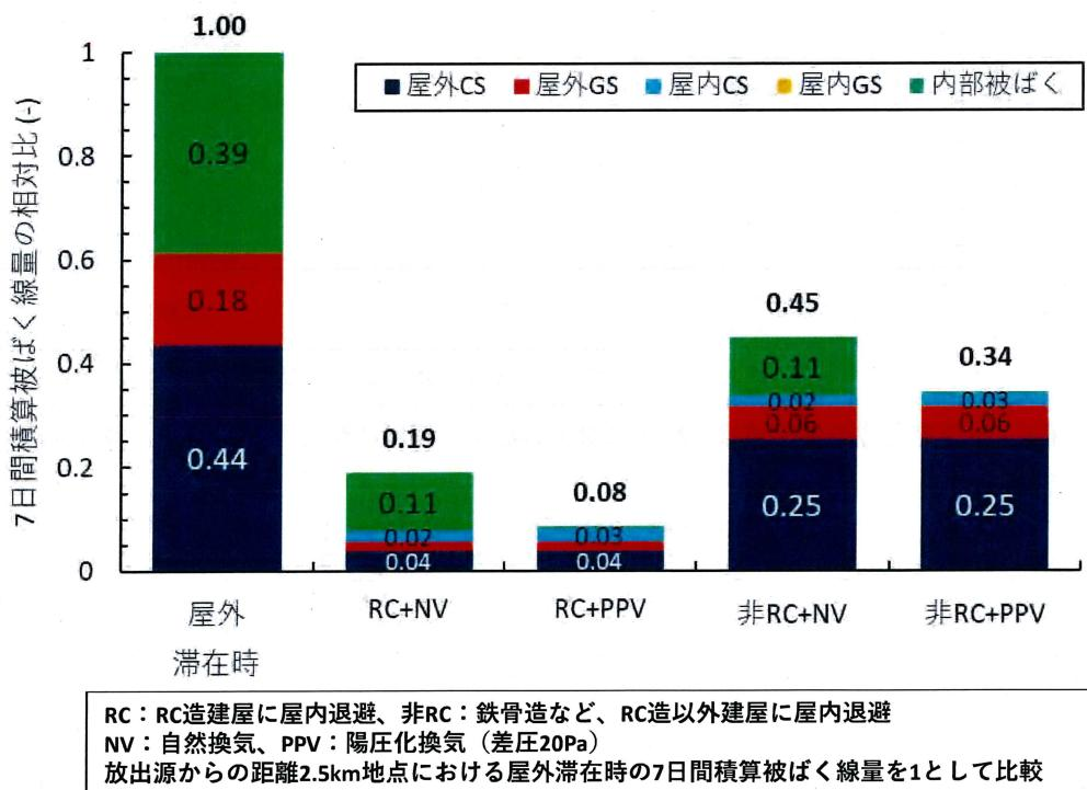
図4 建屋種類ごとの換気別（自然及び陽圧化）の7日間積算被ばく線量の相対比（全核種）
