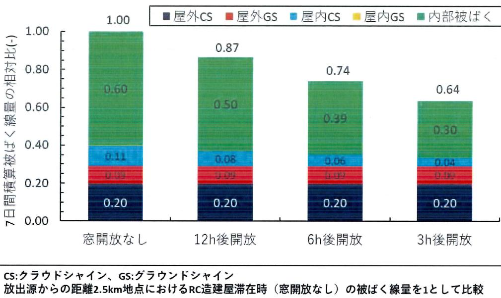
図 10-1 放射性プルーム通過後換気による、自然換気の RC 造建屋に屋内退避した場合の被ばく線量の低減効果<sup>\*)</sup>
