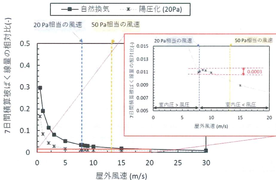
図10 RC造建屋における屋外風速と7日間積算被ばく線量の相対比の関係<sup>\*)</sup>
