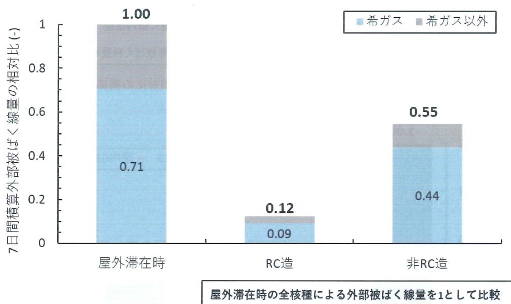
図5 屋外滞在時の外部被ばく線量に対する様々な建屋に屋内退避した場合の外部被ばく線量の相対比<sup>a)</sup>
