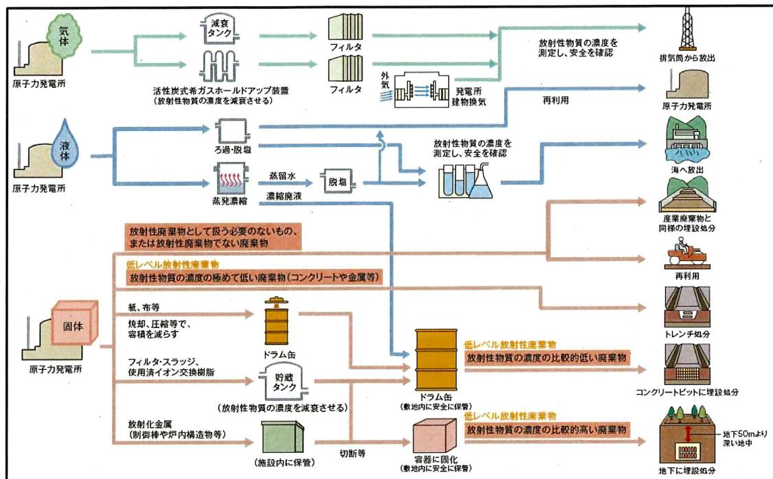
図1 原子炉施設の廃棄物処理方法
