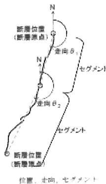
図 12 位置、走向、セグメントの図 【「地震本部レシピ」 p.2 から引用】
