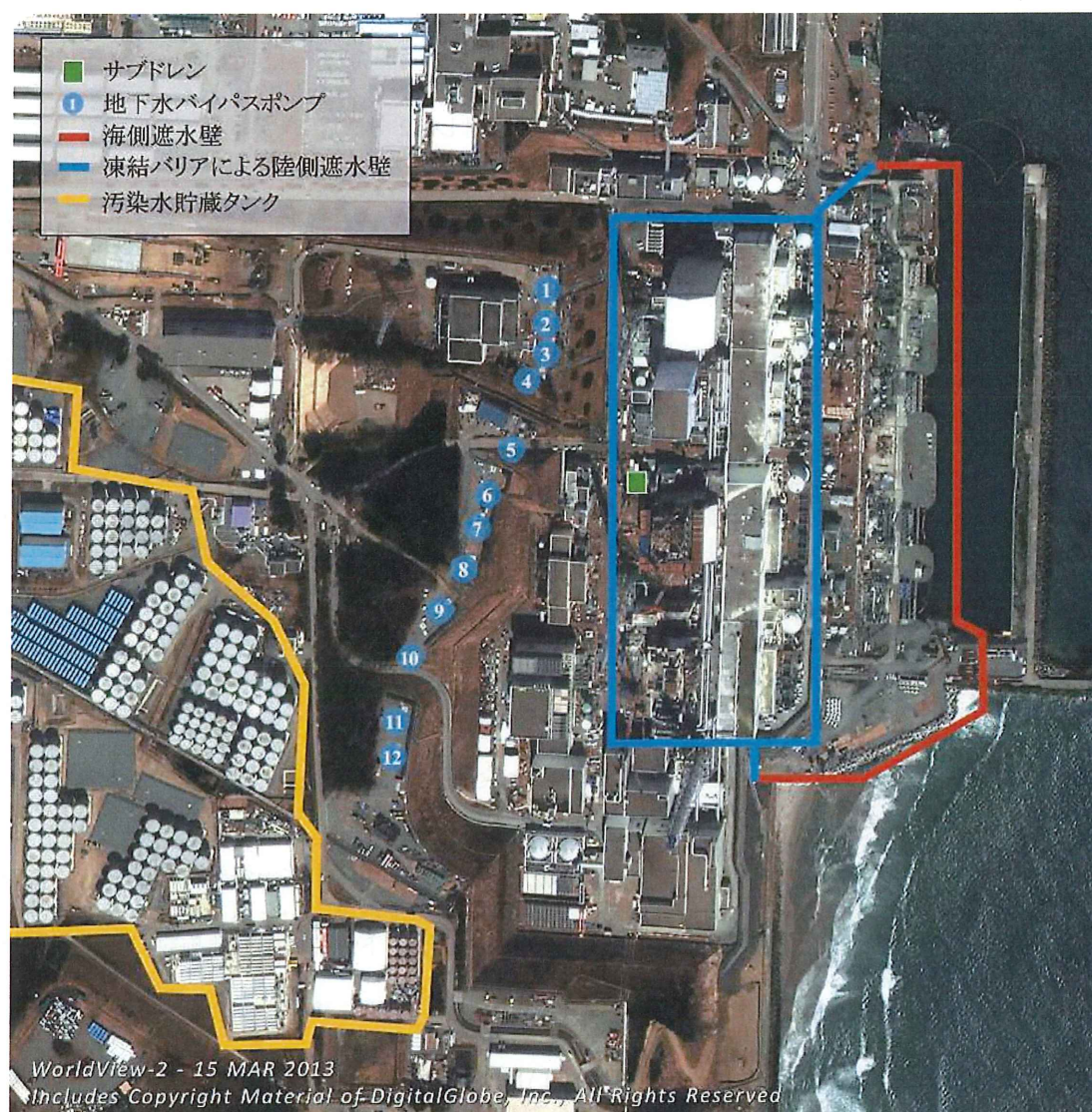
図5.5. 水管理活動の図解。汚染水の貯蔵タンクが左側に示されている[286]。
